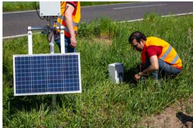
Nima Shokri beim Installieren einer Bodenmessstation
