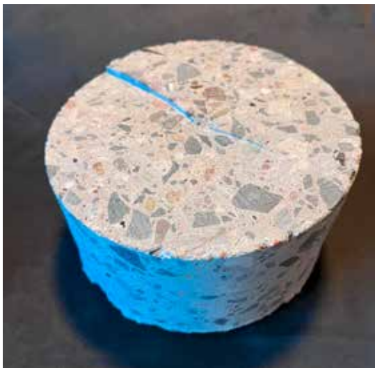
Aus alt mach neu: Diese Form besteht aus einer Betonmischung, die aus abgebrochenem alten Beton und gemischtem Abbruchabfall hergestellt wurde
