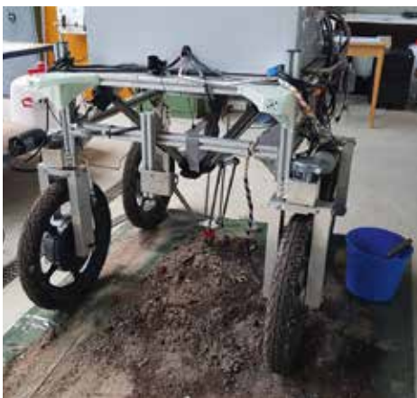
Der Jätroboter beim Einsatz im Labor
