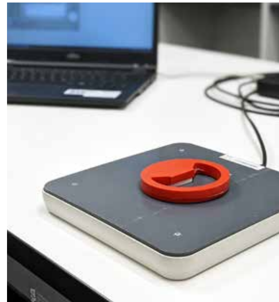
Die Elektronik im Sensor ist mit einer Antenne verbunden, die über eine Radiofrequenz sendet
